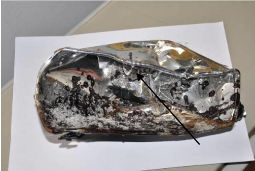
Sl.22 Kućište fara sa razbijenom sijalicom
