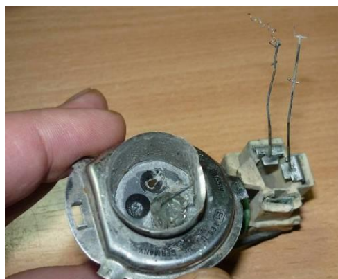
Sl.14 Uparivanje nedostajućih kontakata i elektroda
