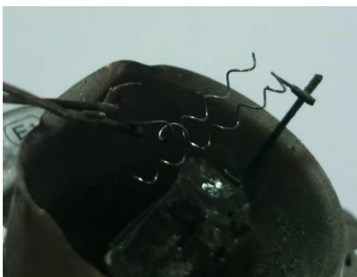
Sl.13 Korak prekinute žarne niti dugog svetla
