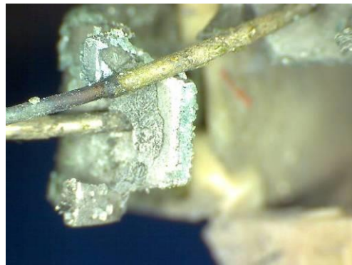
Sl.8 elektrode kratkog i dugačkog svetla (+) sa žarnom niti
