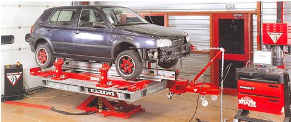
Sl.14 Sto za merenje i ispravljanje oštećene karoserije automobila
